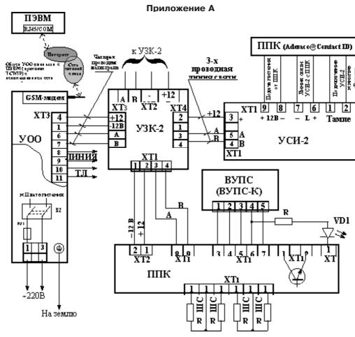
ВУПС выносное устройство постановки/снятия с электронными ключами: ВУПС-К
