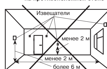
Рисунок 10 – Нерекомендуемые места установки извещателя
