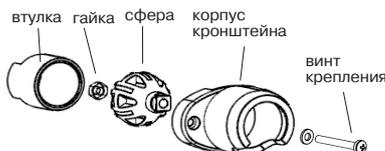
Рисунок 3 – Детали кронштейна
