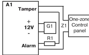
Fig. 1. Wiring diagram of the sensor with combined «Alarm» and «Tammer» signals.
