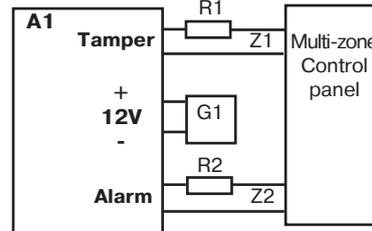
Fig. 2. Wiring diagram of the sensor with separated «Alarm» and «Tammer» signals.
