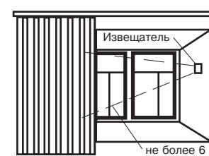
Рисунок 7 – Установка извещателя между стеклом и занавесями (жалюзи)
