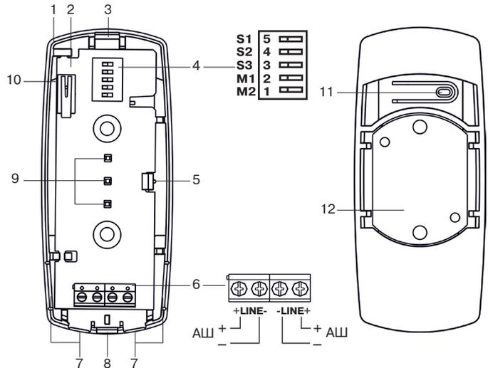
Рисунок 1 – Основание корпуса с печатной платой
