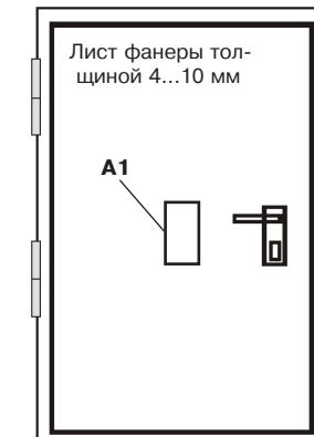
Рисунок 5 – Защита деревянной пустотелой двери
