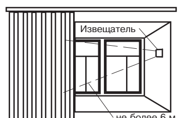
Рисунок 8 – Установка извещателя между стеклом и занавесями (жалюзи)
