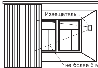
Рисунок 6 – Установка извещателя между стеклом и занавесями (жалюзи)
