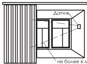
Рисунок 8 – Установка датчика между стеклом и занавесями (жалюзи)
