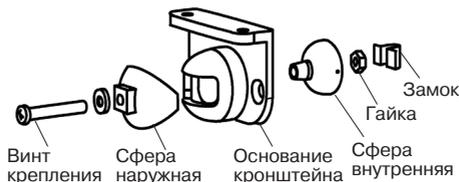
Рисунок 1 – Детали кронштейна
