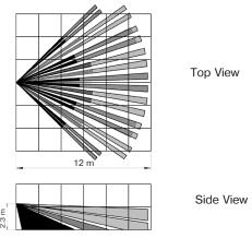
Figure 1 - «Foton-12-1» Detection Pattern
